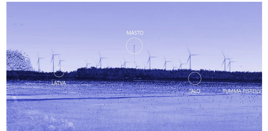
Kuva: esimerkki kiintopisteistä. Pistepilvi (tumma) asettuu valokuvan puuston ja maston kanssa samalle korkeusasemalle. Pistepilven kuvaama puusto perustuu laserkeilaukseen MML:n lentokuvausvuotena. Horisontti ja rakennukset perustuvat MML:n korkeusmalliin ja maastotietokantaan.
